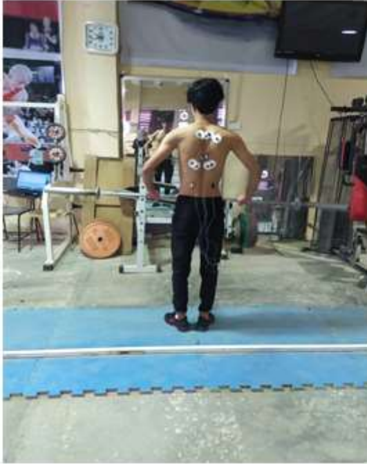
شكل (2) يوضح طريقة وضع اللاقط اثناء اجراء الاختبار ل احد افراد عينة البحث
