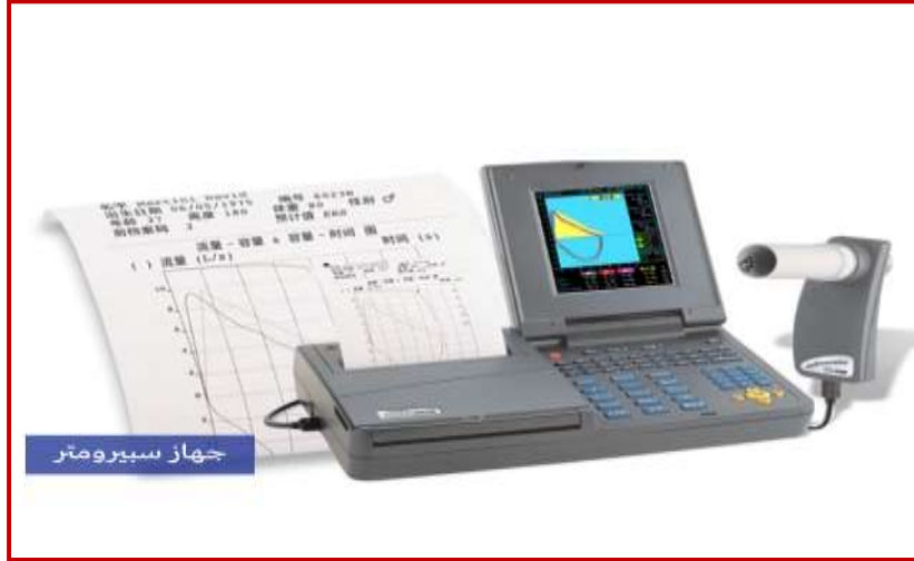
شكل (1) يوضح جهاز سبيروميتر (Spirometer)
