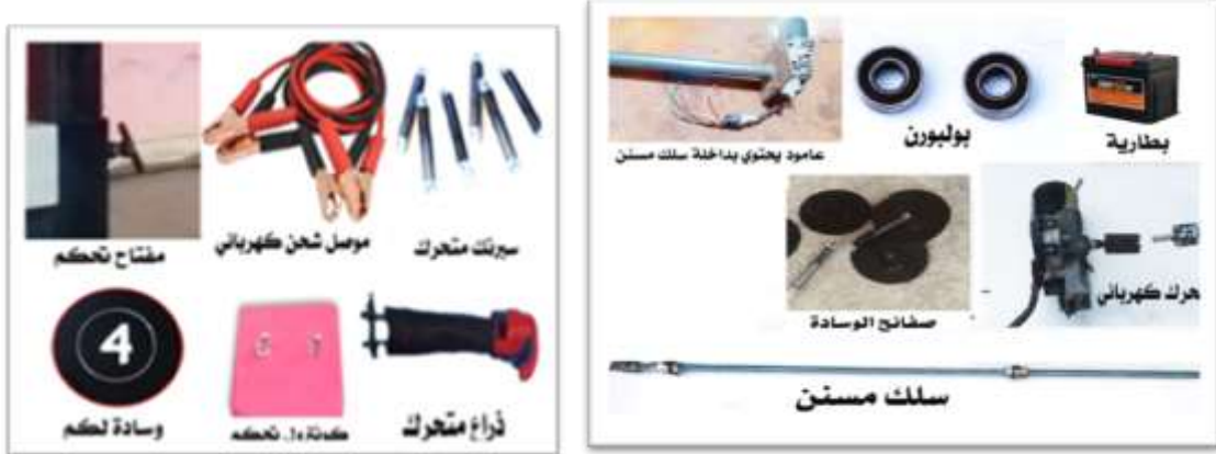
الشكل (1) يوضح مكونات الجهاز المقترح
