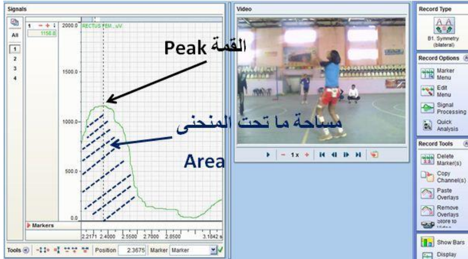
شكل (1) يوضح متغيرات النشاط الكهربائي
